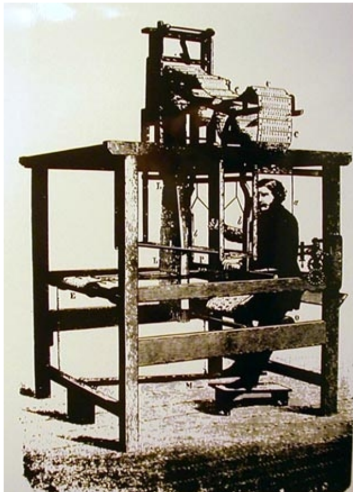
Telaio "alla Jacquard", inventato dal francese Joseph Marie Jacquard, regolato da un meccanismo a schede perforate. Le "pettinatrici Collier", altro genere di macchine presenti a Linate, cimavano invece i panni, con un grado di perfezionamento senza precedenti.
