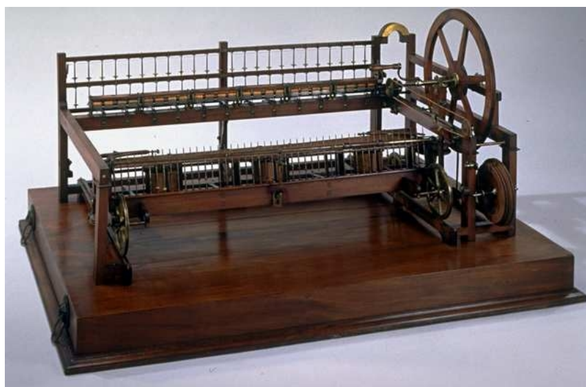
La "mule-Jenny" di Samuel Crompton, filatoio semi-automatico del 1779, unificava il carrello scorrevole della prima "Jenny" e i rulli del filatoio ad acqua. Le invenzioni successive, specialmente quelle dell'inglese Roberts, resero la macchina completamente automatica. Esemplari così modificati erano presenti nello stabilimento linatese.
